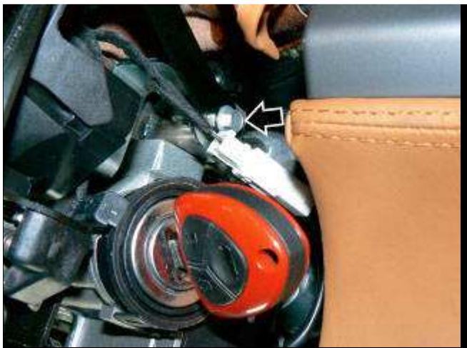
● 松开紧固 F1 换档拨片的右侧侧面螺钉。
